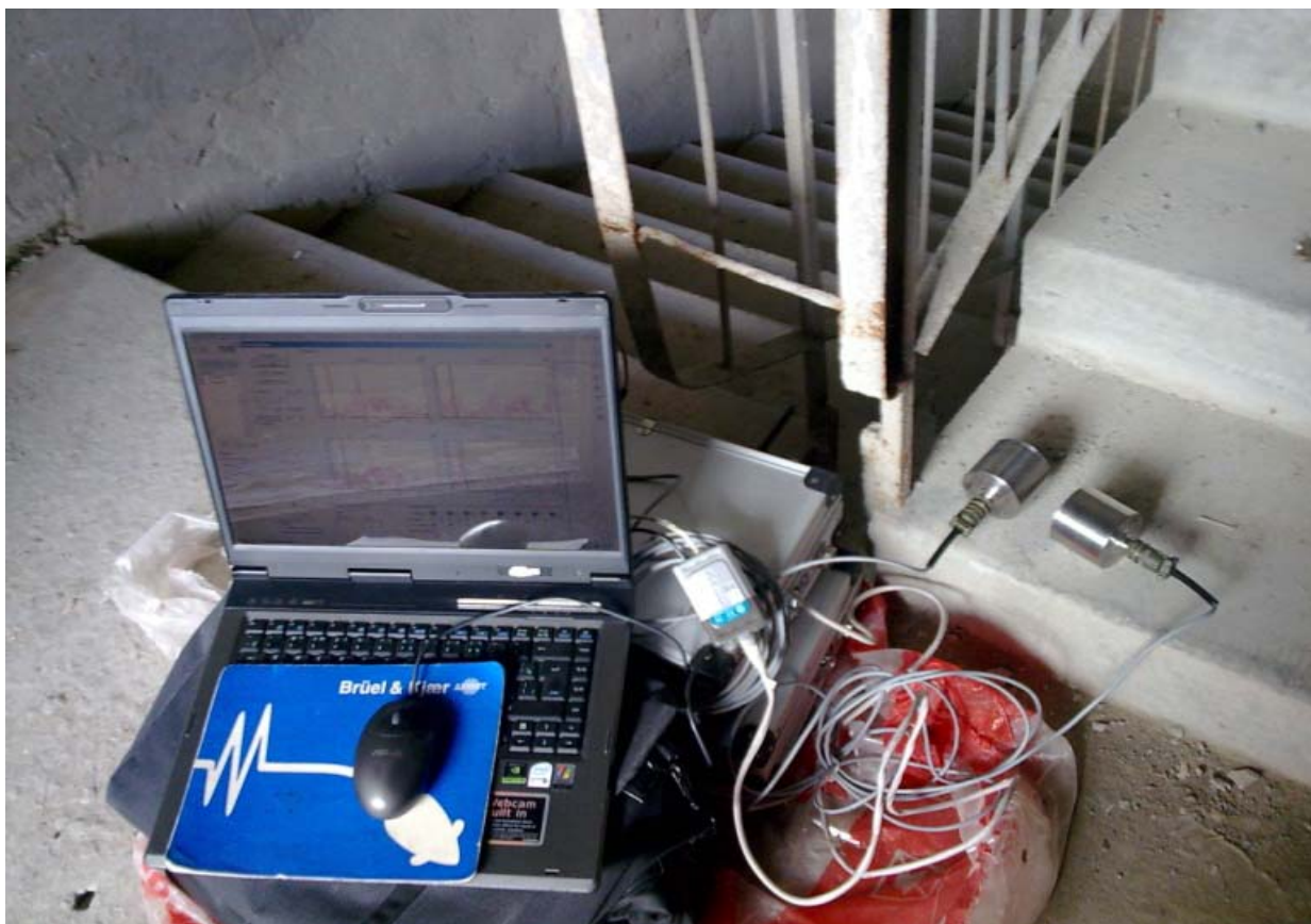
Мобільна апаратура для виміру віброприскорень на поверхні ґрунту та будівельних конструкціях
