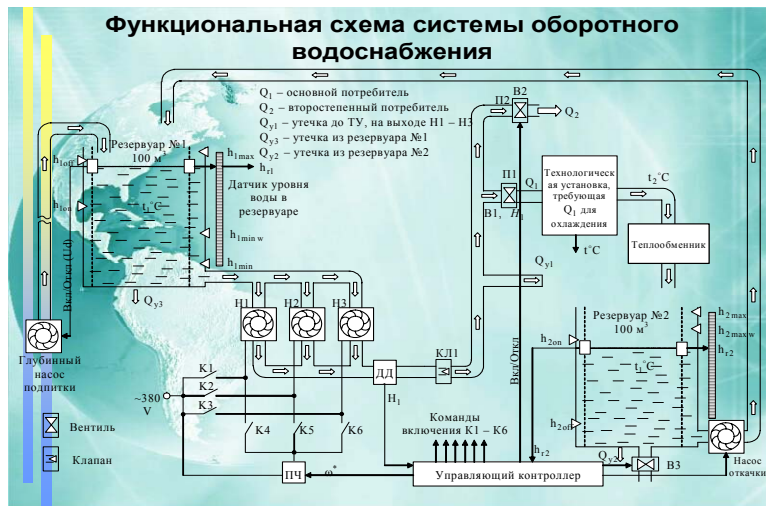
Функціональна схема водопровідної глибинної системи водопостачання
