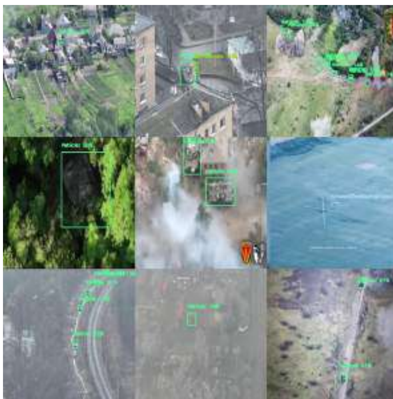
Рисунок 3. Результати роботи мережі на кадрах із камер дронів
