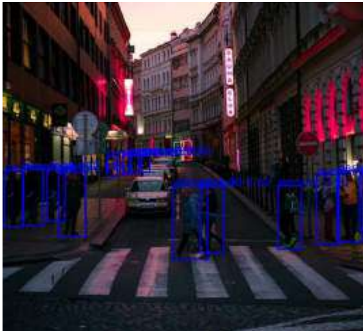
Рисунок 3. Результати роботи мережі в умовах поганого освітлення
